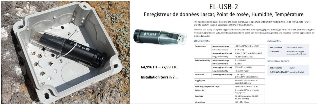
Figure 46 : Modèle de capteur utilisé pour l'étude microclimatique.
