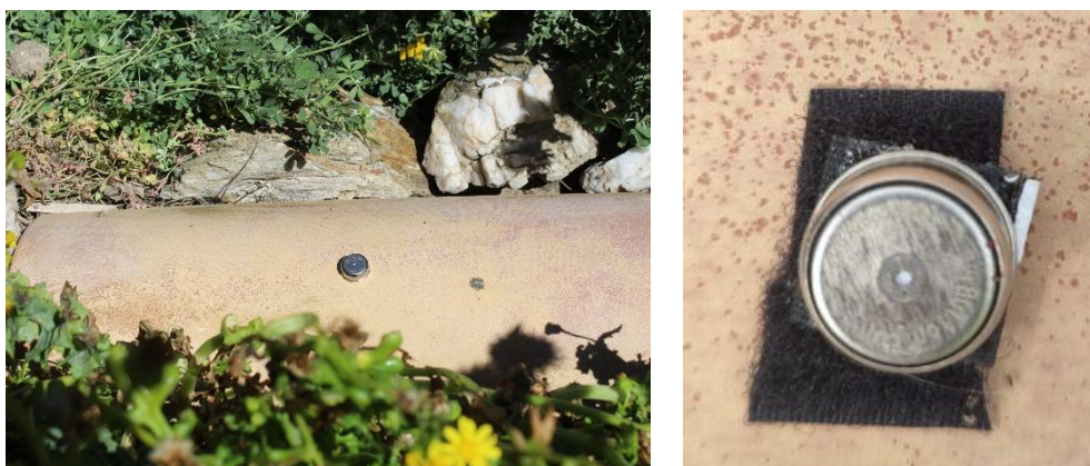
Figure 35 : Micro-capteur installé sous la première tuile d'un gîte.
