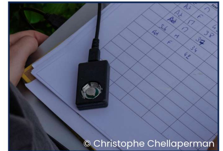
Schéma d'un capteur Thermochron® – Hygrochron™ iButton® et son lecteur
