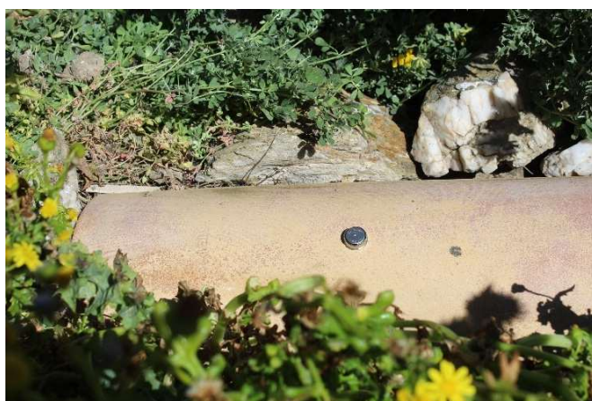
Figure 25 : Thermoboutons (micro-capteurs utilisés sous la première tuile des gîtes artificiels)
