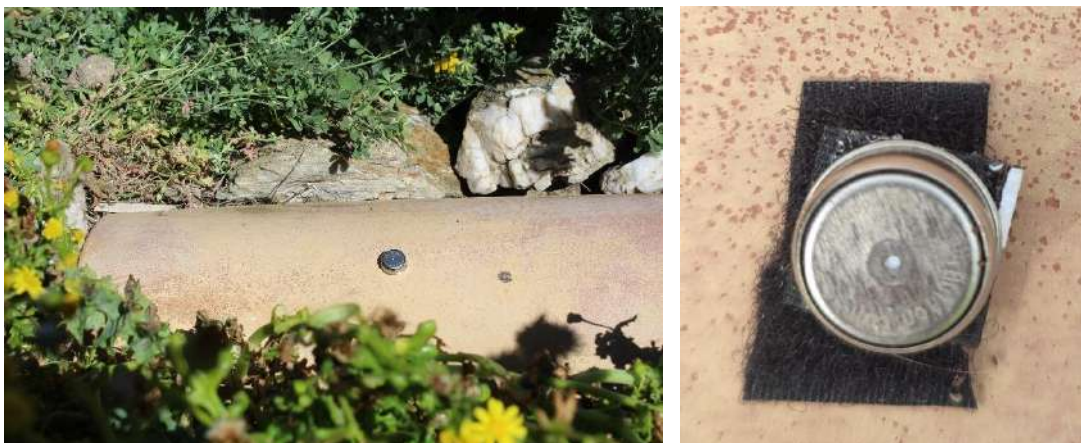
Figure 25 : Thermoboutons (micro-capteurs utilisés sous la première tuile des gîtes artificiels)
