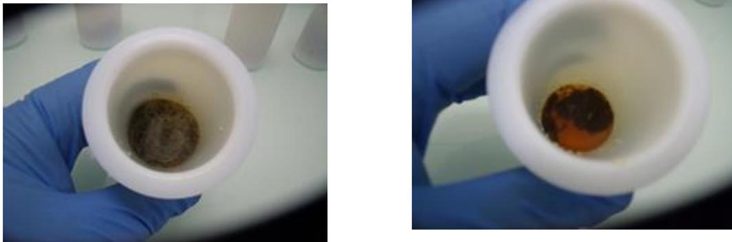
Figure 4.2-5 : Echantillon de duvet lyophilisé dans réacteur en Téflon avant (photographie de gauche) et après (photographie de droite) ajout du mélange d'acides concentrés.
