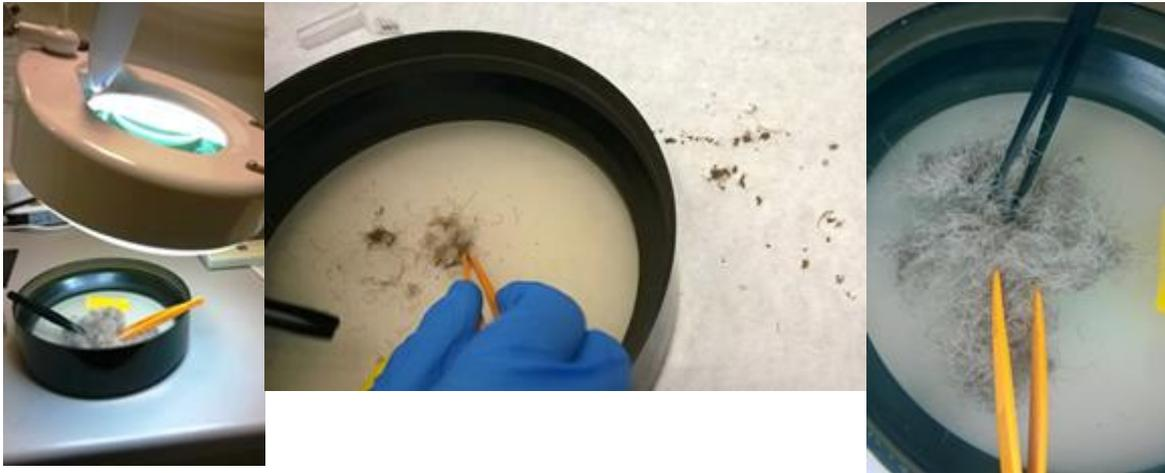
Figure 4.2-1 : Tri manuel des échantillons de duvets sous loupe à lumière intégrée avec pinces plastiques (photographies de gauche), et exemple d'échantillon trié obtenu (photographie de droite).
