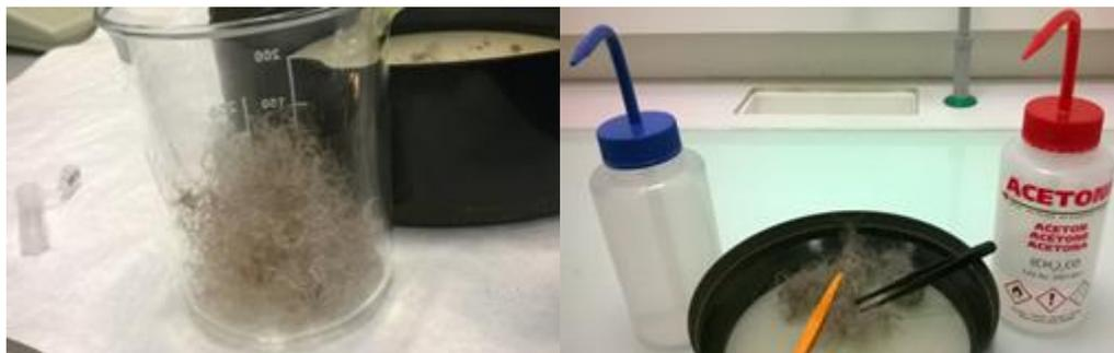
Figure 4.2-2 : Echantillon de duvet trié dans un bécher de 200 mL pour lavage à l'eau UHQ et ultra-sons (photographie de gauche), et dernières étapes de rinçages à l'acétone puis à l'eau UHQ (photographie de droite).
