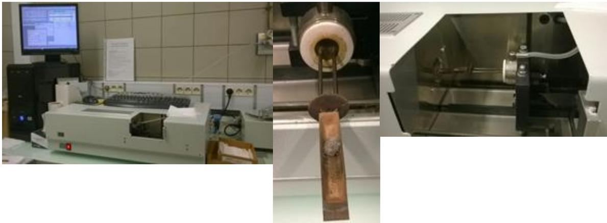
Figure 4.2-8 : AAS Leco AMA 254 pour l'analyse de Hg (photographie de gauche) ; nacelle en Ti contenant un échantillon de duvets lyophilisés (photographie centrale) ; système d'introduction de la nacelle dans l'analyseur de Hg (photographie de droite).
