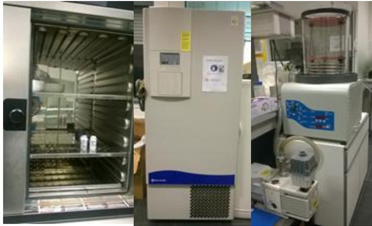
Figure 4.2-3 : Flacons à scintillation de stockage en PEHD de 25 mL avec gaze sur l'ouverture dans l'étuve à 40°C (photographie de gauche) ; congélateur à -80°C (photographie centrale) ; lyophilisateur sous vide et à -80°C (photographie de droite).
