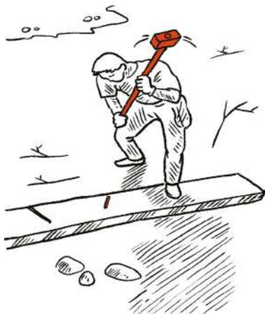
**ETAPA 4 :** Fijar el escalón al suelo clavando el hierro corrugado con ayuda de la maza (10 cm en sustrato duro ; 40cm en sustrato blando y hasta 1 m en sustrato arenoso).
