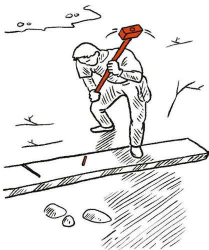
**ÉTAPE 4 :** Fixer la marche au sol en enfonçant les fers à béton, à l'aide d'une masse (10 cm sur substrat dur ; 40cm sur substrat meuble et jusqu'à 1 m dans le sable).
