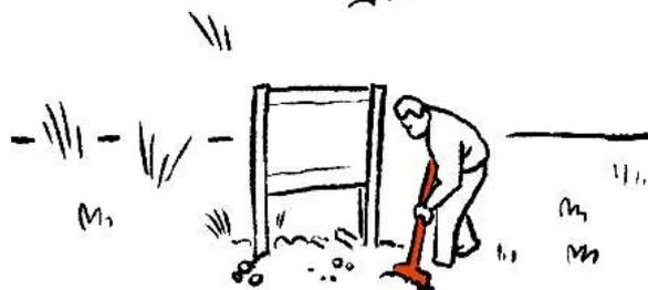
**ÉTAPE 7 :** Reboucher le trou avec la terre d'excavation et, dans l'idéal, arroser la terre d'excavation (1 ou 2 seaux d'eau de mer) pour favoriser l'infiltration de la terre dans les interstices et donc son tassement
