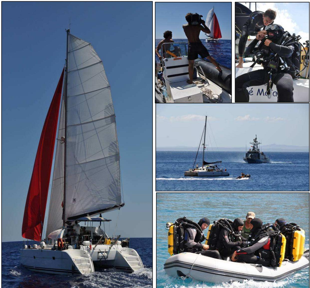
**Figure 5 : Différents moyens à la mer ont été mobilisés pour la mission en Tunisie. Un catamaran Lagoon 380 a servi de support sonar, bathymétrie, transects plongeur audio et base de vie, et un navire semi-rigide de 6 mètres et un de 4,60 mètres ont permis la réalisation des plongées ponctuelles.**
