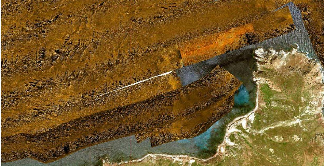
Figure 9: Exemple de couverture au sonar latéral au Nord-Ouest de la Galite.
