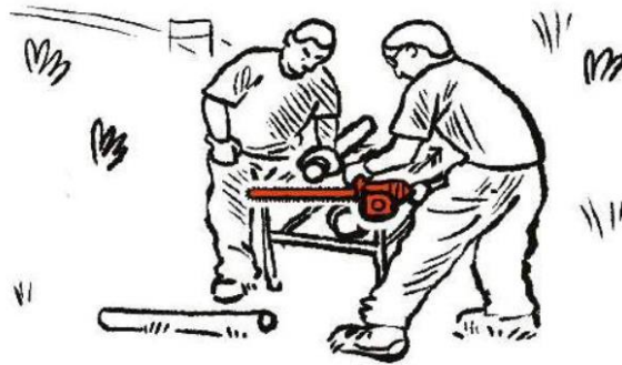
Étape 3 : Avec la mèche bois, percer un trou au centre du piquet sur 20 cm de profondeur
