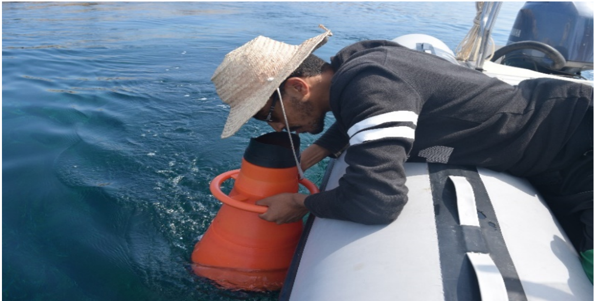
Figure 10. Observation du fond avec la lunette de Calfat et prise de position avec GPS
