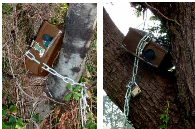
Figure 2 : dispositifs d'écoute ultrasonore (SM2) installés sur l'île Saint-Honorat
