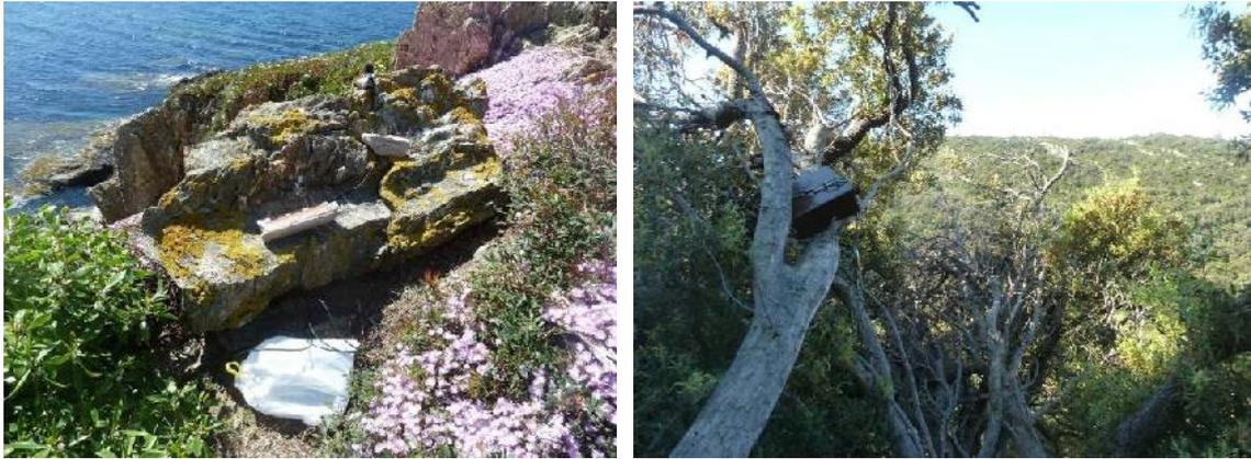
Figure 2 : dispositifs d'écoute ultrasonore (SM2) installés sur les îles et îlots à inventorier
