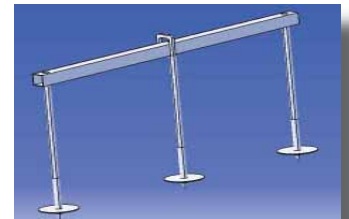
Modèle 4 : Vis à sable avec barre d'accouplement
